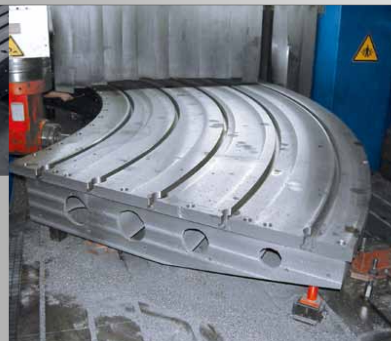
Segment otočného stolu o průměru 10.000 mm
