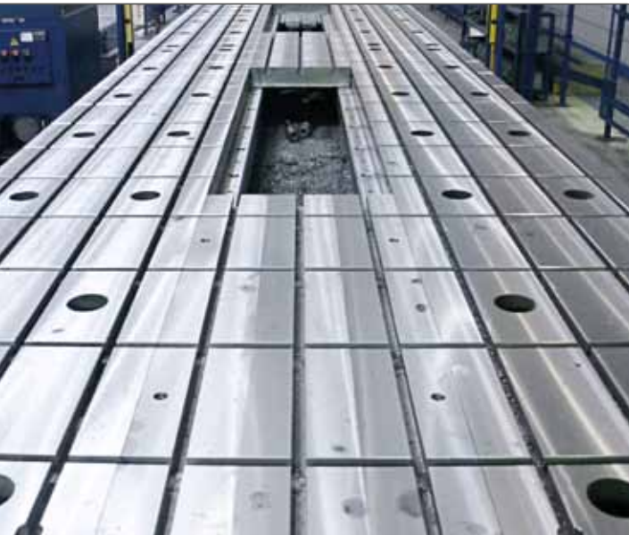
Lože portálového stroje s montážními plochami a závitovými otvory pro vodicí lišty
