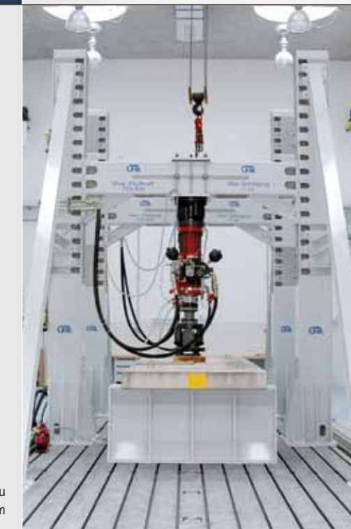
Těžký upínací úhelník pro zkušebnu elektromotorů, 2.200 x 1.800 x 2.000 mm
