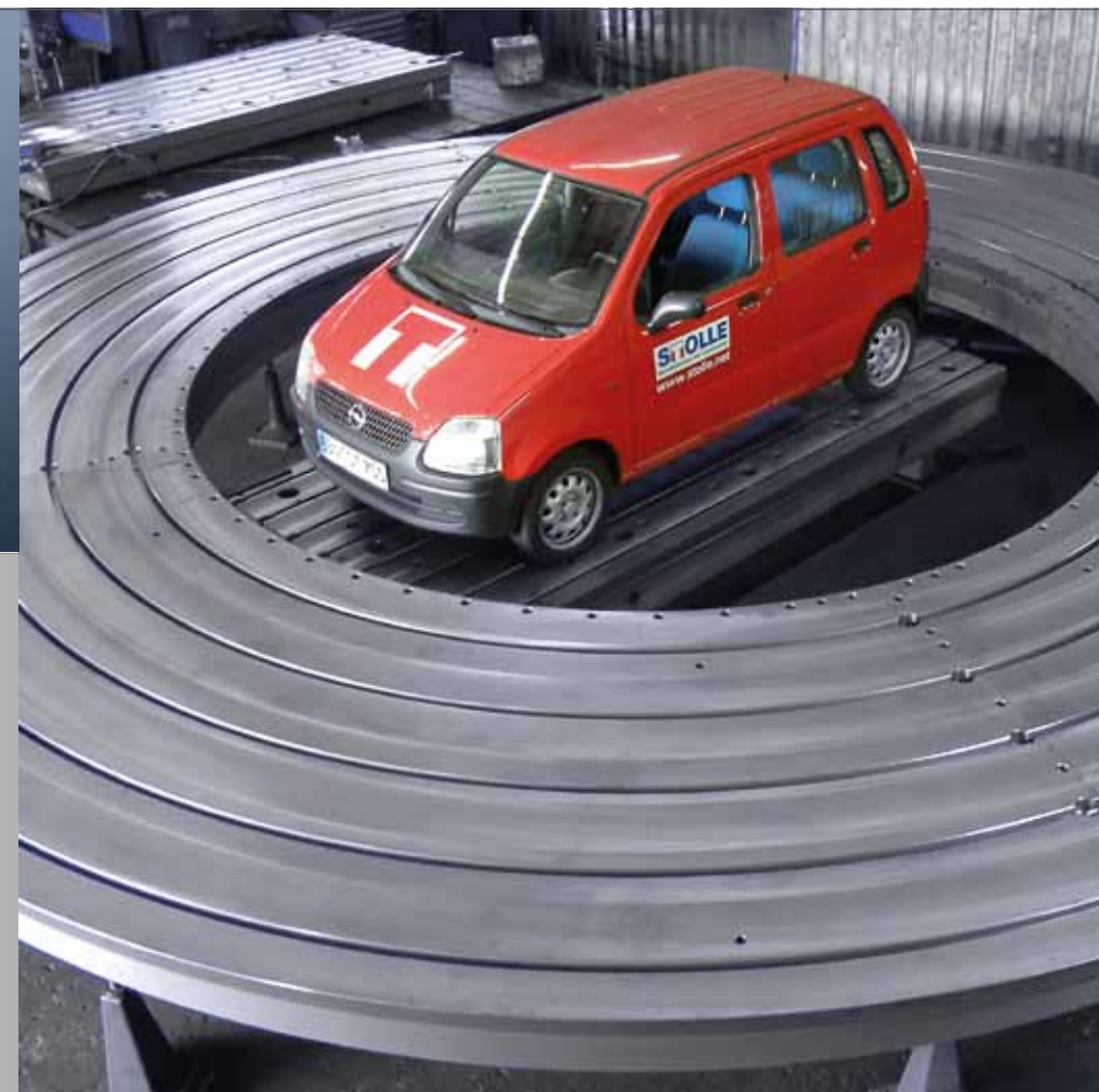
Rozšíření otočného stolu pro opracování lodních šroubů, průměr 10.000 mm
